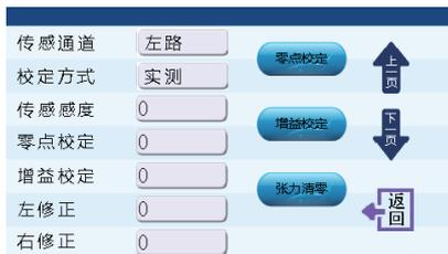
TCN-002张力控制器在张力传感器模式下,接张力传感器反馈,需进行张力的零点校定和增益校定,<张力相关>参数组中的<校定单位>和<张力校定>参数组决定了校定过程及结果,下面就参数组各个参数作具体说明。
